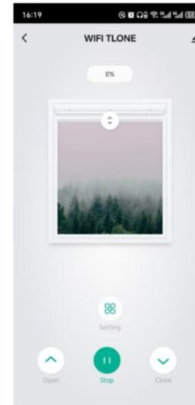
Wählen Sie „WIFI TLONE“, um die Bedienoberfläche aufzurufen und das Anheben des Bildschirms über die mobile App zu steuern. Auf der Bedienoberfläche können Sie durch Klicken auf den entsprechenden Befehl das Anheben, Anhalten und Absenken des Bildschirms steuern. Achtung: **Klicken Sie nicht auf die Spalte „Richtungsänderung“.**
