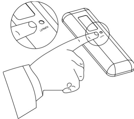
Drücken Sie mit einem spitzen Gegenstand dreimal schnell hintereinander die Taste „LEARN“ auf der Rückseite der Fernbedienung. Der Motor vibriert einmal auf und ab und befindet sich im Pairing-Modus.
