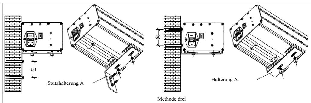
(Optional) Installation der Teleskopplattform: Wie auf dem Bild gezeigt, platzieren Sie die Halterung für die Teleskopplattform am unteren Rand des Bildschirmgehäuses und installieren Sie die Teleskopplattform in der Mitte.
